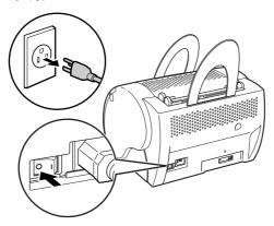
**2** 用软布沾上水或用水稀释的中性洗涤剂。拧干布上的水或洗涤剂 → 用此布擦拭打印机除去脏污。
