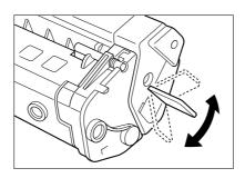
6 用一只手牢固抓住硒鼓的同时,沿下图所示的方向拉密封带。
