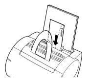
2 将导纸器调整到纸张的宽度。
