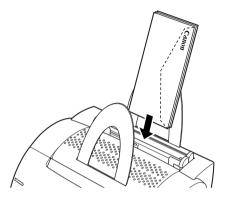
2 将导纸器调整到信封叠的宽度。
