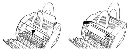
请勿将纸张从纸张入口向上拉,否则会损坏打印机。轻轻地将纸张从打印机中抽出。
