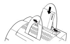
如果信封口盖沿着信封的长边,插入信封时使信封口盖位于背面和右面。如果信封口盖沿着信封的短边,插入信封时使信封口盖位于底面和背面。
