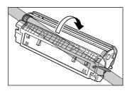
• 请勿触摸硒鼓保护罩。避免以用手接触硒鼓保护罩这种方式处理硒鼓。
